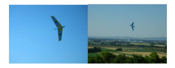
Ich würde sagen, der eingebaute AXI ist der perfekte Motor für den Hai 2, mit seinem Fluggewicht von 1490g, einer Motorlaufzeit von 4:20 und einem LiPo 3S 2400mA/h sind locker sieben/ acht 45 Grad Steigflüge und Flugzeiten bis 25 Minuten drinnen, je nach Thermik und Funfaktor, der Hai macht alles mit! Als Regler ist ein Jeti Advance 40A mit BEC eingesetzt, funkt störungsfrei. Programmiert hab ich alles was man mit einer Vier Klappen Fläche programmieren kann:
